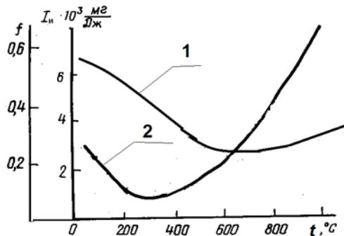
Рис. 3. Зависимость коэффициента трения (1) и интенсивности износа (2) от температуры поверхности трения при трении колесной стали в паре с легированным чугуном ЧНМХ при вертикальной нагрузке 1,5 МПа [9]
