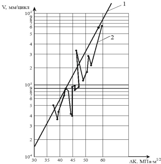
**Рис. 5. Кинетические диаграммы усталостного разрушения при циклическом нагружении с частотой 0,1 Гц стали 20 после: 1 - нормализации; 2 - ЛЛ(В)+Н, лазерные дорожки нанесены без перекрытия**
