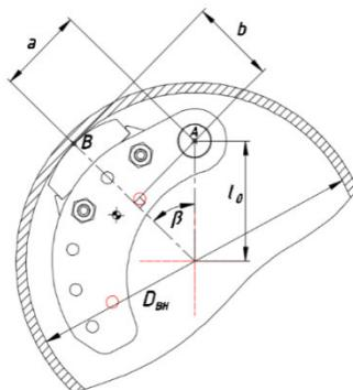
**Рис. 2. Схема определения положения фрикционной накладки углом установки  $\beta$  (пружины не показаны)**
