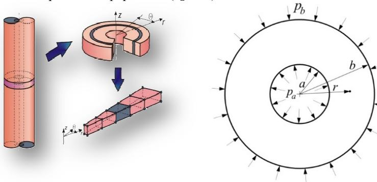
**Рис. 1. Расчетная схема для толстостенного цилиндра [3]**
