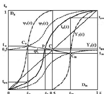
**Рис. 1. Гипсоцентроидная модель изнашивания [1]**
