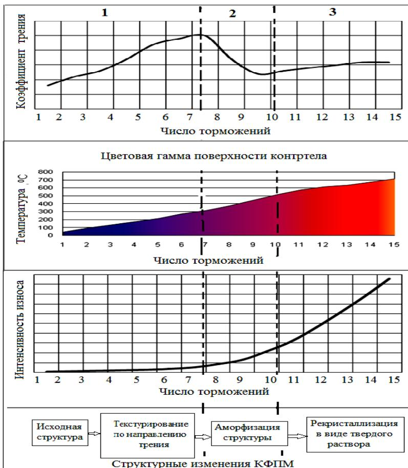
**Рис. 2. Взаимосвязь температурных зон коэффициента трения и интенсивности износа со структурными изменениями**
