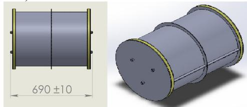
**Рис. 4. Сборка теплоизоляционной конструкции из двух блоков**
