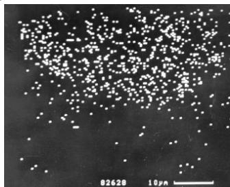
**Рис. 1. Распределение ванадия в зоне лазерного легирования**
