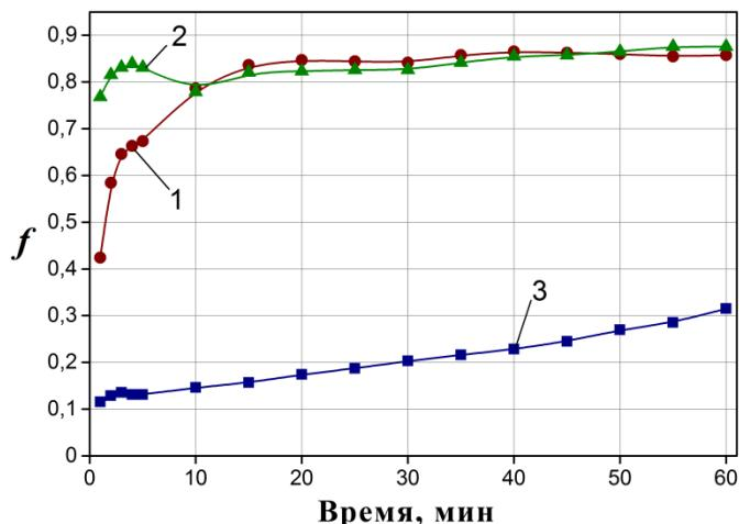
Рис. 1. Зависимости коэффициента трения от продолжительности испытаний без смазочной среды керамического шара по:
