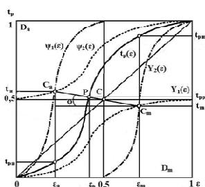
Рис. 1. Гипсоцентроидная модель изнашивания [1]
