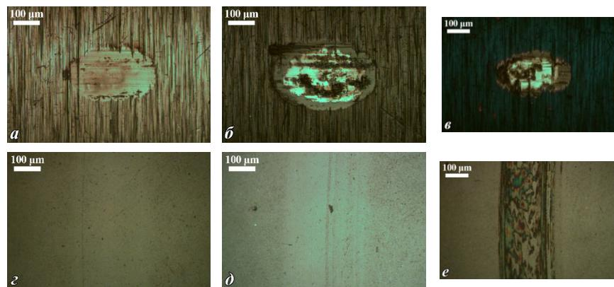
Рис. 4. Микрофотографии пятен износа на роликах (а, б, в) и дорожки износа на керамическом шаре (г, д, е) при испытании в PAO-4 образца из стали без покрытия (а, г), с AlTiN (б, д), с AlTiN-DLC (в, е)
