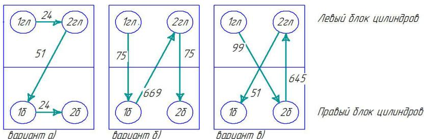
Примечание: Стрелки характеризуют порядок начала такта "Рабочий ход", цифры – значение угла ПКВ между цилиндрами.
