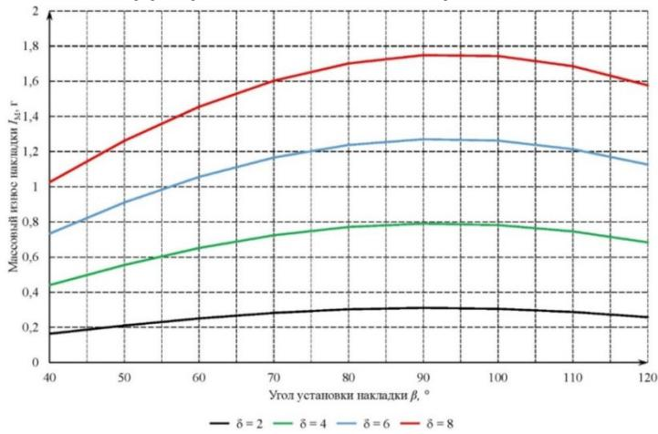
**Рис. 6. Зависимость массового износа  $I_M$  фрикционной накладки ЦФР, выполненной из ФПМ типа ЭМ-1, от угла  $\beta$  её установки и угла дополнительного поворота  $\delta$  тормозной колодки**
