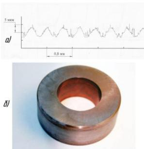
**Рис. 2. Деформирующая фильтрация с РМР поверхности рабочего канала, полностью покрытая «серповидной плёнкой» после волочения в среде металлоплакирующей смазки.**
