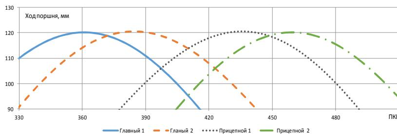
**Рис. 3. Расположение поршней в ВМТ секции W-образного двигателя**
