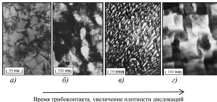
**Рис. 2. Изменение дислокационной структуры металлической поверхности в процессе трения [9]**
