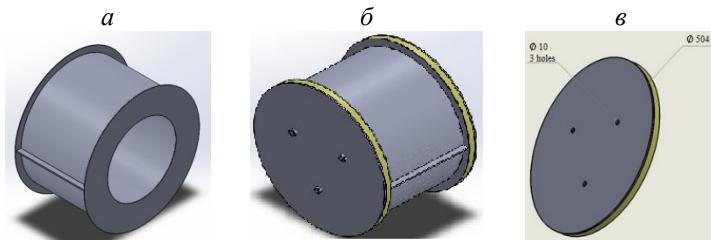
**Рис. 2. Модель блоков сквозной (а), торцевой (б) теплоизоляции, торцевой диск с минеральной теплоизоляцией с внутренней стороны (в)**
