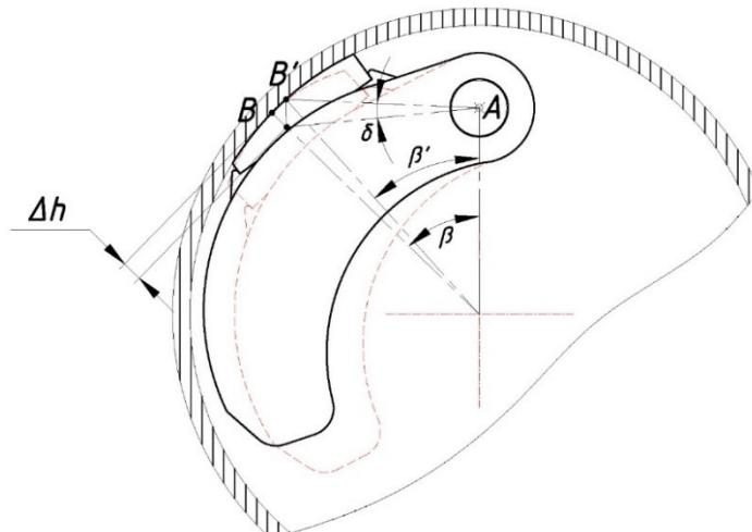
**Рис. 3. Схема изменения положения тормозной колодки в процессе износа  $\Delta h$  фрикционной накладки ЦФР**
