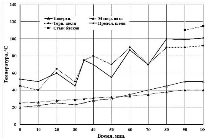
Рис. 5. Кинетика изменения средних температур наружных поверхностей теплоизоляционных конструкций из одного блока и стыка двух блоков
