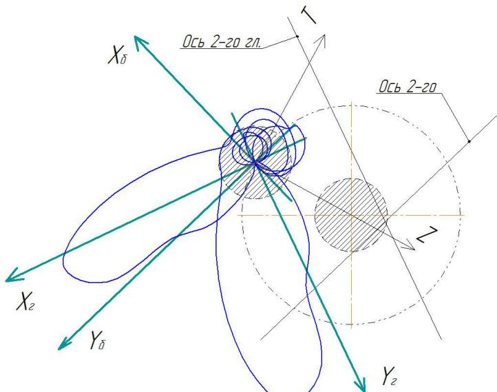
**Рис. 5. Характер изменения годографа силы « $T$  от  $Z$ » второго шатунного подшипника секции двигателя**
