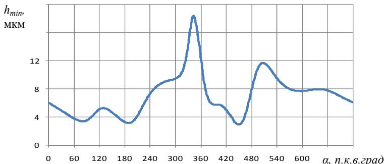
**Рис. 6. Зависимость минимальной толщины смазочного слоя
