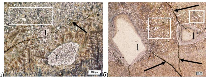
Рис. 4. Микроструктура наплавленного слоя с 0,18–0,355мм (а) и 0,5–0,71 мм (б) зернами твердосплавного инструмента: □ – матрица наплавленного слоя с карбидами тугоплавких металлов; 1 – твердосплавные зерна;
