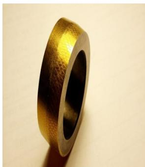
**Рис.1 Деформирующий элемент для дорнования отверстий по патенту РФ №2560477 с РМР поверхности и износостойким покрытием.**
