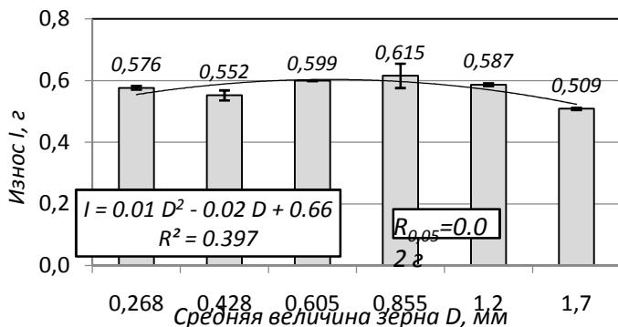
Рис. 3. Влияние средней величины зерна наплавленного слоя на износ (пара трения трех тел «сталь – абразив – наплавленный слой»)
