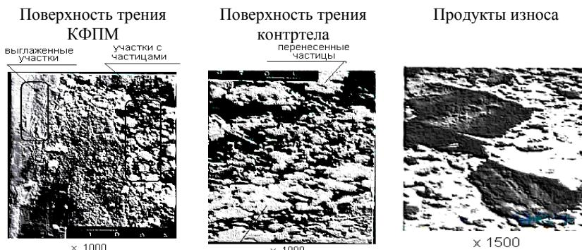
**Рис. 3. Типичный вид поверхностей трения КФПМ, металлических контртел и продуктов износа**
