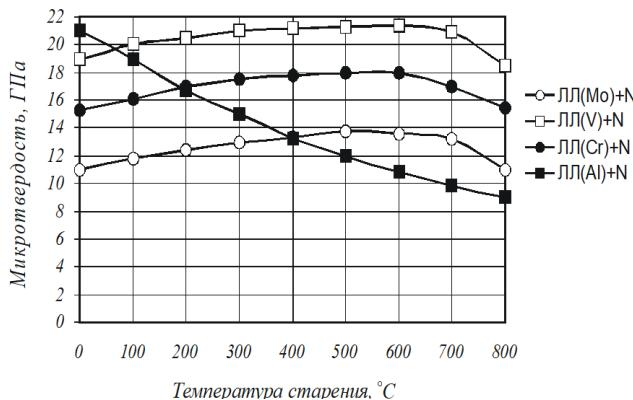
Рис. 4. Влияние температуры старения на микротвердость модифицированной поверхности стали 20 (длительность выдержки 30 мин)
