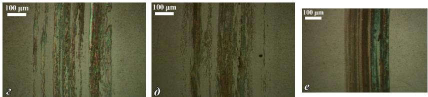
Рис. 2. Микрофотографии пятен износа на роликах (*a, b, c*) и дорожки износа на керамическом шаре (*d, e*) при испытании без смазочного материала образца из стали без покрытия (*a, d*), с AlTiN (*b, e*), с AlTiN-DLC (*c, e*)
