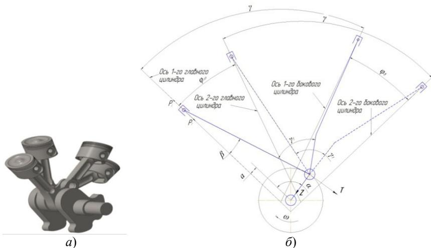
**Рис. 1. Общий вид а) и кинематическая схема б) секции W-образного двигателя с прицепными шатунами**
