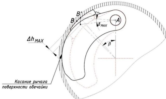
**Рис. 4. Схема максимального дополнительного угла  $\delta_{MAX}$  поворота тормозной колодки ЦФР**
