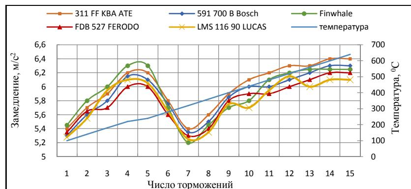
Рис.1. Зависимости коэффициента трения от температуры различных безасбестовых тормозных материалов при  $P_a = 2,0$  МПа,  $V_{ck} = 16,7$  м/с
