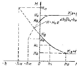
Рис. 2. Склеробатическая модель изнашивания [1]
