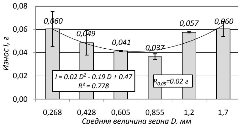
**Рис. 2. Влияние средней величины зерна наплавленного слоя на износ
