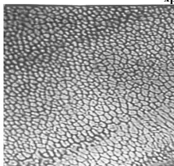
**Рис. 3. Микроструктура стали 20 после лазерного легирования хромом, x1000**
