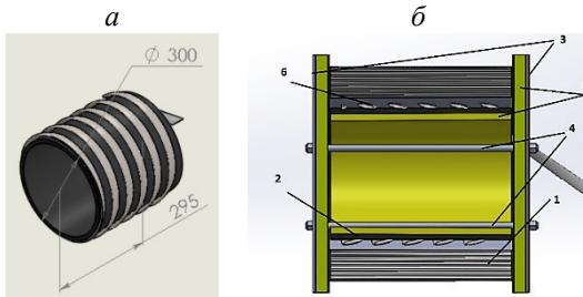
**Рис. 3. Модель электронагревательной ленты (а) и нагревательная лента в составе сборной теплоизоляционной цилиндрической конструкции (б):**
