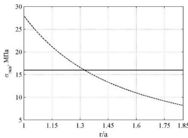
Рис. 3. Распределение эквивалентных напряжений для равнонапряженного и однородного цилиндра [1]
