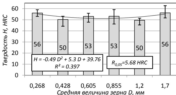
**Рис. 1. Влияние средней величины зерна твердого сплава на твердость наплавленных слоев**
