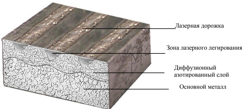
**Рис .3. Формирование упрочненного слоя на стальной поверхности при лазерном легировании с последующим азотированием**
