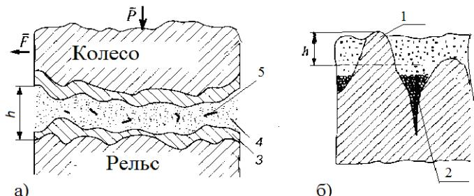
Рис. 1. Схема взаимодействия колеса с рельсом
