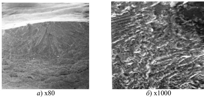
**Рис. 6. Фрактограммы усталостного разрушения стали 20 после:
