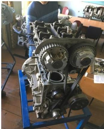
**Рис. 2. Стенд со стороны привода газораспределения**
