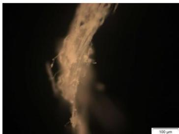
**Рис. 1. Фотография целлюлозы в отраженном свете по первому способу**
