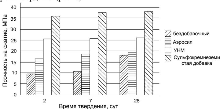
**Рис. 1. Прочность цементного камня в зависимости от вида добавки**
