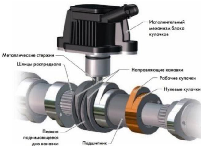
**Рис. 3. Принцип действия механизма отключения клапанов двигателя Volkswagen TSI [4]**
