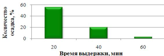
**Рис. 1. Влияние времени выдержки при температуре  $900\text{ }^\circ\text{C}$  на количество не растворившегося осадка**
