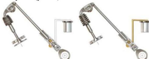
**Рис. 1. Система Multi-Displacement System [2]**
