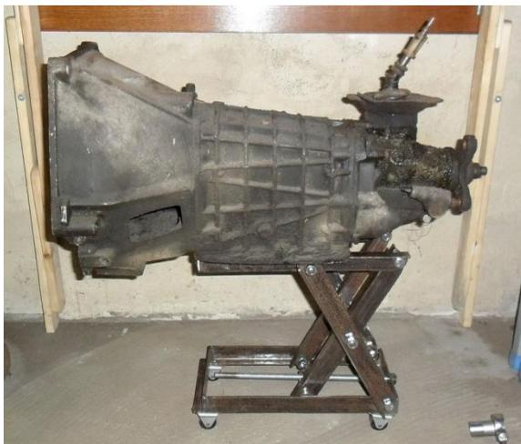
**Рис. 2. Трансмиссия, установленная на приспособление для снятия и установки агрегатов**
