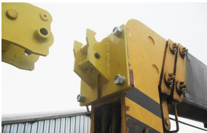
Рис. 3. Узел крепления для быстрого монтажа-демонтажа люльки [1]
