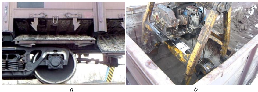
Рис. 1. Смёрзшийся груз в железнодорожных полувагонах: а – смёрзшийся щебень при разгрузке через нижние люки; б – замерзшая песчаная смесь, которую невозможно разгрузить грейферным захватом
