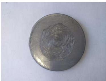
Рис. 1. Образец трибологических испытаний сталь по стали
