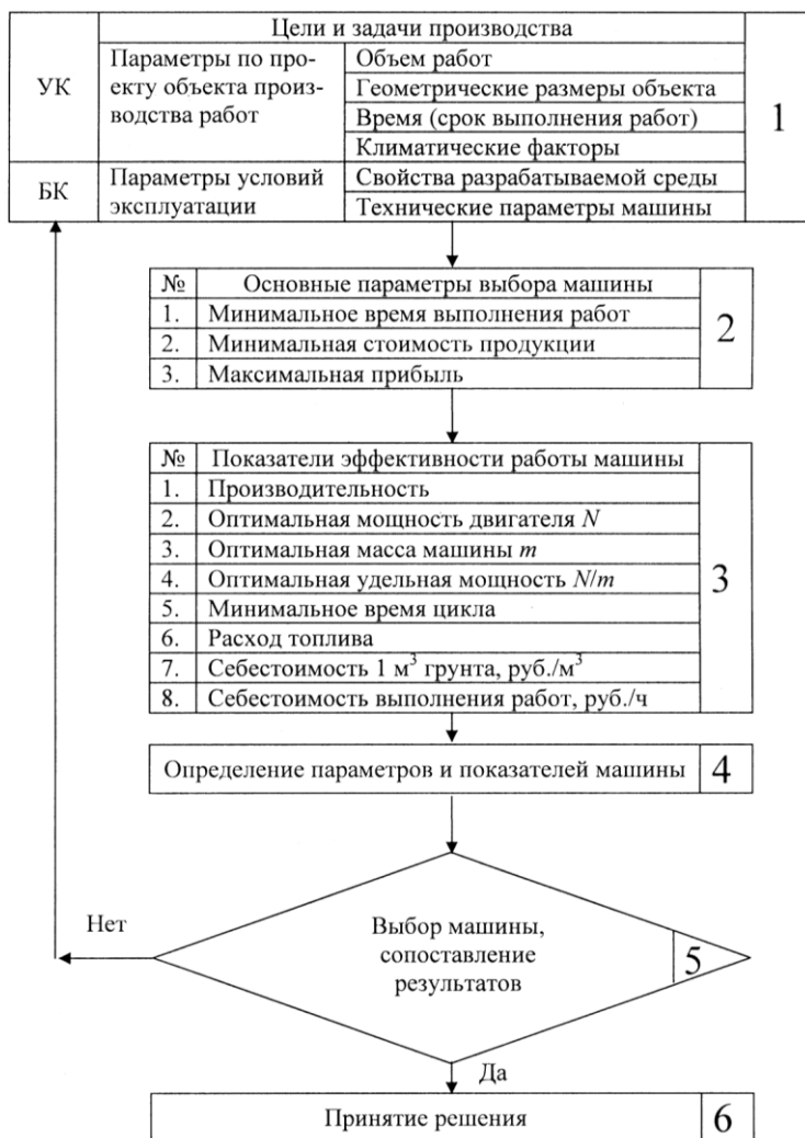
Рис. 1. Схема определения оптимальных параметров и режимов работы и выбора машины в зависимости от условий эксплуатации
