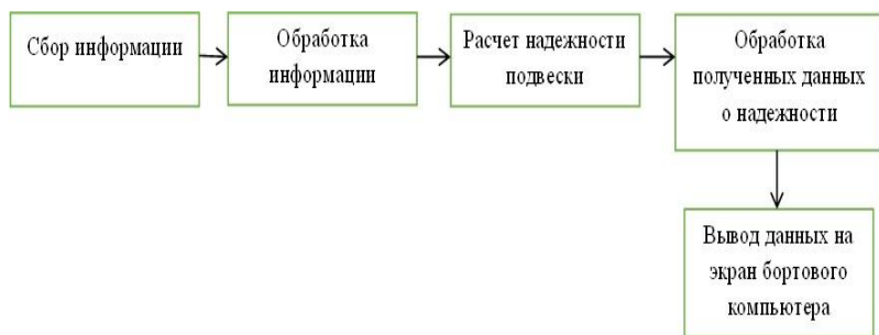
Рис. 2. Принцип получения информации о техническом состоянии ходовой части
