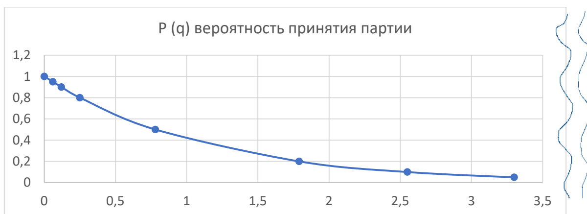
Рис. 2. Оперативная характеристика для плана контроля Б 4,0 В
