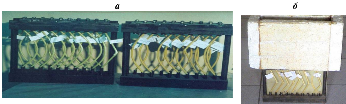
Рис. 4. Стенды для испытаний одновременно 20 образцов СПА-5,5: а - на долговечность при продольном изгибе; б - футляры для сохранения температуры образцов Fig. 4. Test benches for 20 SPA-5.5 samples at the same time: a - for durability during longitudinal bending; b - cases for maintaining the temperature of the samples
